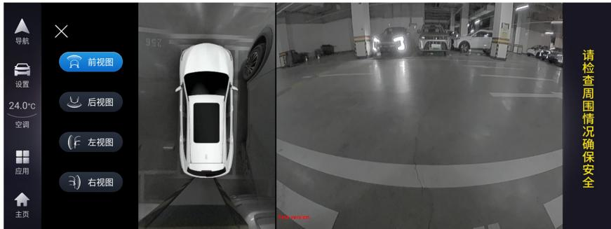
当您需要关闭全景显示时，可通过方向盘左下方仪表板左下盖板上的全景开关关闭全景模式。注意：点击全景开关关闭后，全景模式将一直处于关闭状态，如需开启，请再次点击全景开关。
