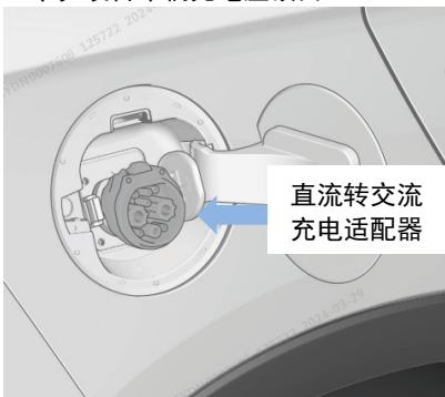
6. 将直流充电桩正确插入车辆直流转交流适配器，插合完成后，直流充电桩锁止卡扣咬合适配器锁口
