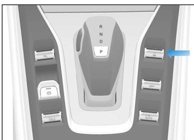
如果按下 ESC off 开关时间小于 10s 后，仪表上指示灯被点亮，表示 ESC 已关闭，TCS 和 ESC 功能将被禁用。再次按下 ESC off 开关，仪表上指示灯熄灭。表示 ESC
