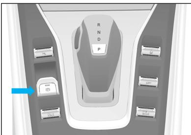
当车辆停稳时，拉起 EPB 开关按钮，驻车制动器夹紧，仪表驻车指示灯 **P** 点亮、EPB 开关按钮上 LED 灯点亮。
