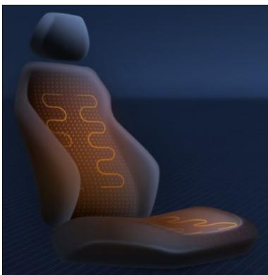
前排座椅有加热功能，共有三挡模式调节，车辆通电后，点击触摸屏上座椅加热按钮座椅开始加热，初始默认为 3 挡
