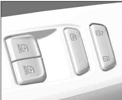
锁栓处于“闭锁”位置时，从车内不能打开该车门。欲打开此车门，需使用车外的车门把手。
