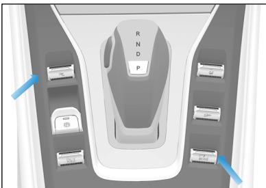
通过中控台的 EV/HEV 按钮(图示左上)可切换为 EV 或者 HEV 模式，切换至相应模式后，仪表会有对应的模式显示；通过 DRIVE MODE 按钮(图示右下)可切换 ECO/NORMAL/SPORT，即经济/标准/运动三种驾驶模式(可在触摸屏-驾驶偏好设置是否记忆)。
