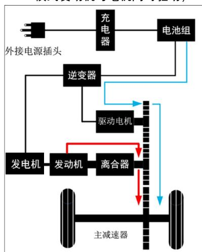
■ HEV 模式发动机驱动电机发电回收能量；
