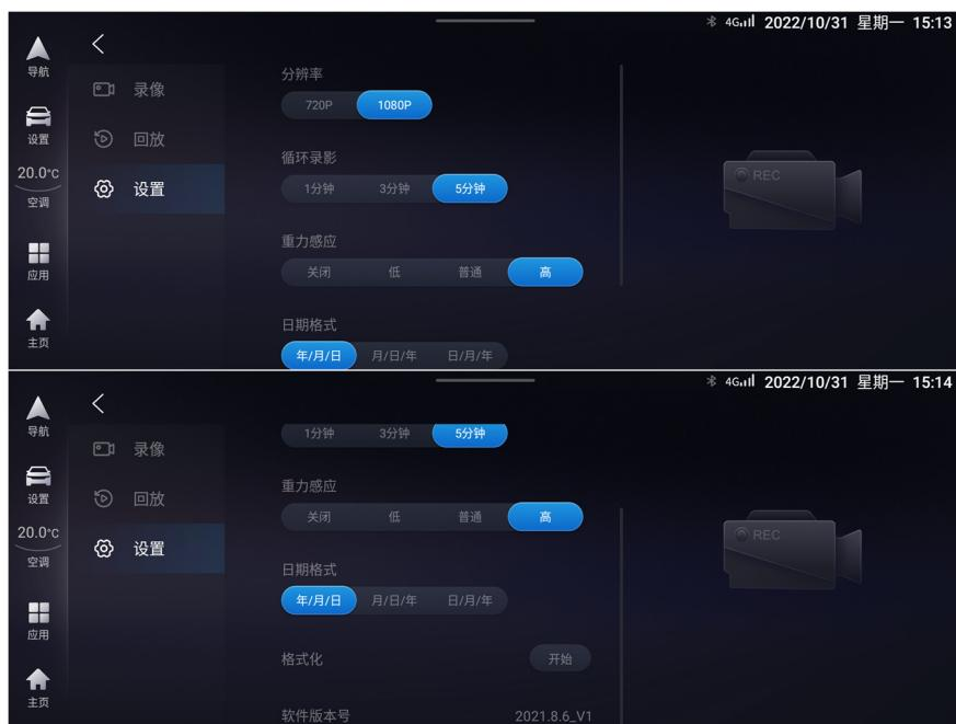
触摸屏可对行车记录仪的参数进行设置。在实时预览界面，触摸左侧设置按钮，进入设置界面，可以对分辨率、循环录影、重力感应、日期格式、格式化等进行自定义设置。
