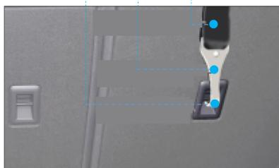
将卡钩紧扣到固定锚支座上，并紧固顶部拉带，确保将顶部拉带扣牢。
