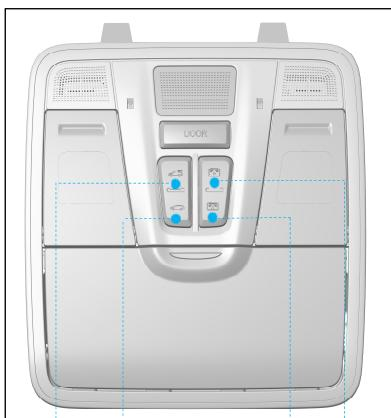
▷ 说明：分长按（手动模式）和短按（自动模式），短按时间 $\leqslant 500\text{ms}$ ，长按时间 $>500\text{ms}$ 。
