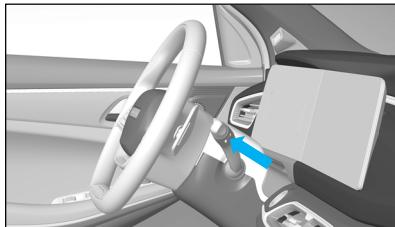
操作洗涤器，向上（图示箭头方向）拨动雨刮开关手柄直至在挡风玻璃上喷出所需洗涤液量，随后雨刮器将自动工作几次。
