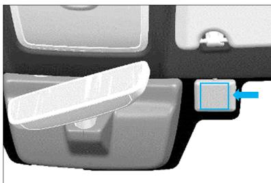
微波窗口中的 ETC 是电子不停车收费系统，采用电子收费方式，ETC 系统通过安装于车辆上的车载装置和安装在收费站车道上的天线之间进行无线通信和信息交换，主要由车辆自动识别系统、中心管理系统和其他辅助设施等组成。汽车的 ETC 一般安装在车内反光镜的右侧位置，ETC 的安装位置如下图所示，安装后激活：
