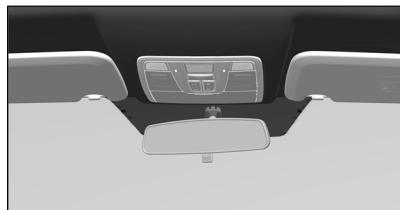
手动防眩：向后拨动内后视镜中下方的调节杆，进入防眩模式；向前拨动内后视镜中下方的调节杆，退出防眩模式。
