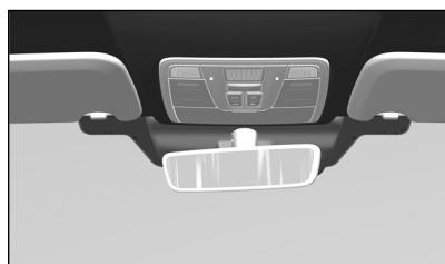
自动调节：除在倒车挡外，内后视镜会根据后车大灯的眩目程度而自动成比例地变暗。
