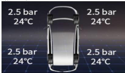
轮胎的压力和温度可以通过胎压传感器检测后通过域控制器将信息反馈给仪表，在仪表显示屏上实时显示。
