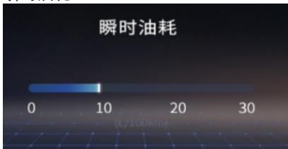
显示当前车辆瞬时油耗，车辆运动时显示单位 L/100km，车辆静止时显示单位 L/h。
