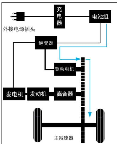
► 在 HEV 模式下，低电量或大功率需求时，发动机启动进入串联模式，满足动力性需求。
