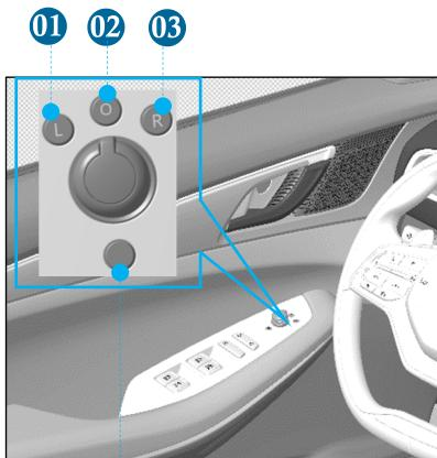
1. 外后视镜调节：旋转开关以选择①或③（左或右），拨动调节旋钮可对应调节外后视镜镜片的上、下、左、右角度；
