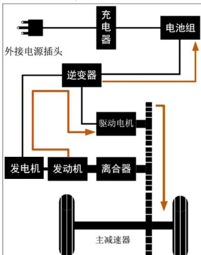
■ HEV 模式发动机发电及电池放电供驱动电机驱动。
