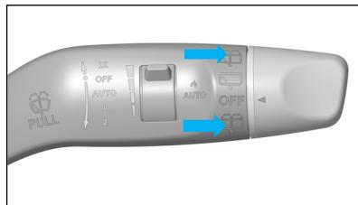
当后雨刮旋钮箭头旋至图示后洗涤档位时，可打开后窗洗涤，保持旋钮位置至后窗玻璃上喷出所需洗涤液量后，松开旋钮，旋钮自动回位，后窗洗涤关闭。
