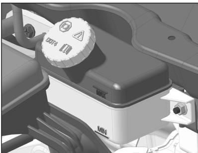
通过查看储液罐一侧的外部标记, 目测检查液位, 而无需拆卸罐盖。
