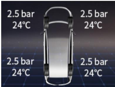
3. 胎压系统报警分为：低压报警、高压报警、高温报警、传感器电池电量低报警和传感器信号丢失五种报警机制，当出现胎压系统报警时，组合仪表上的胎压系统故障指示灯 会点亮，且会有相应的故障现象文字提示。
