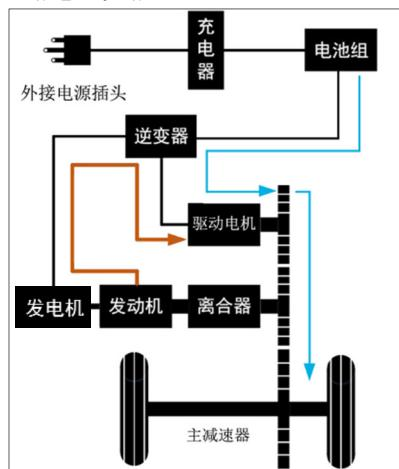
▷ 在 HEV 模式下，中高速车速，部分工况发动机启动进入并联模式，提高燃油经济性。
