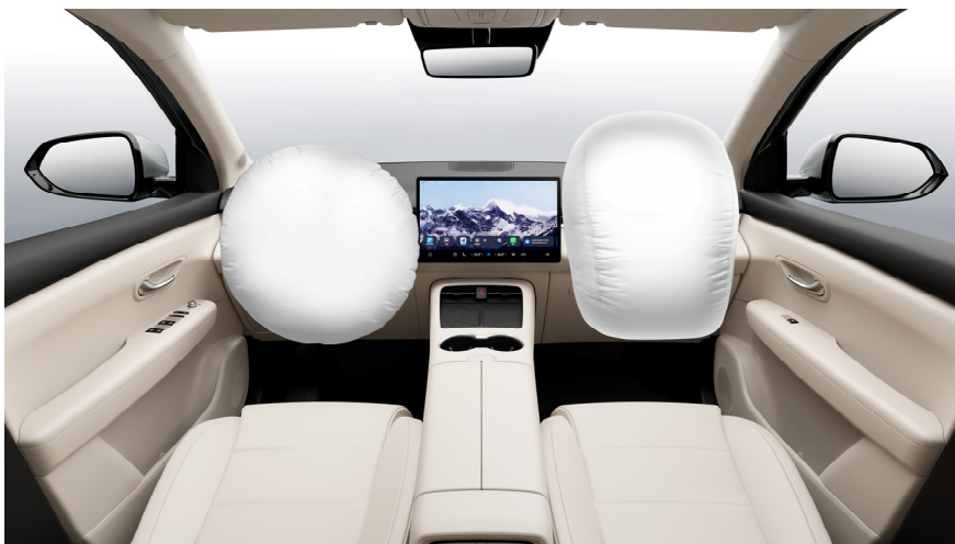
主副驾驶气囊爆破展开情形图
