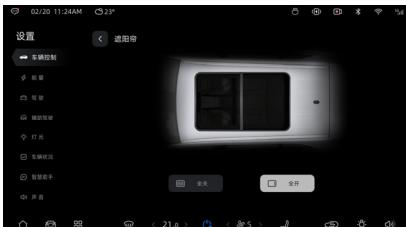
在中控屏进入设置 > 车辆控制，点击遮阳帘，展开遮阳帘调节选项，可控制遮阳帘全开或全关。
