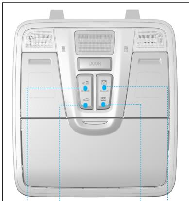
▷ 说明：分长按（手动模式）和短按（自动模式）， $50\text{ms} < \text{短按时间} \leq 350\text{ms}$ ，长按时间 $\geq 350\text{ms}$ 。
