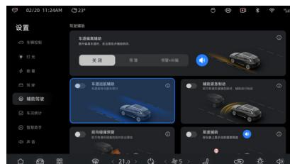
点击设置>辅助驾驶>车道巡航辅助开关图标点亮，开启该功能；再次点击开关变灰关闭该功能。
