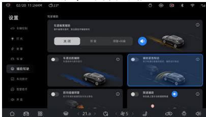
点击设置>辅助驾驶>辅助紧急制动开关至图标点亮，开启该功能。
