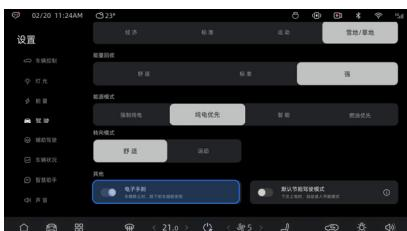
停稳车辆，踩住刹车踏板。切换到 P 挡自动开启电子手刹或在中控屏点击**设置>驾驶>其他**，开启电子手刹，仪表驻车指示灯①点亮。
