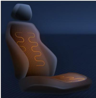
前排座椅有加热功能，共有三挡模式调节，车辆通电后，点击中控屏上座椅加热按钮座椅开始加热，初始默认为3挡（请参阅 [座椅温度控制设置](#) 见第139页）。
