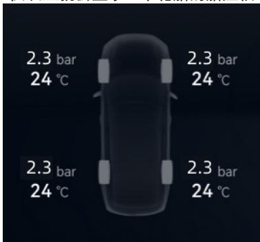
3. 胎压系统报警分为: 低压报警、高压报警、高温报警、传感器电池电量低报警和传感器信号丢失五种报警机制,当出现胎压系统报警时,组合仪表上的胎压系统故障指示灯
