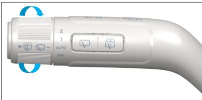
2 挡：将组合控制拨杆旋钮旋转至该挡位，前风挡雨刮连续高速刮刷。
