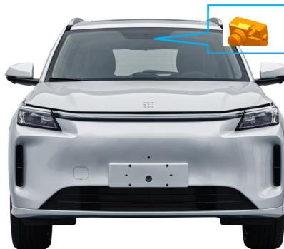
车辆配备行车记录仪, 记录仪标清摄像头安装在内后视镜后方的多功能传感器罩内, 系统将车辆行驶途中的影像、声音、车况等完整记录下来, 可以快速、真实、准确地利用影像资料协助交警进行公平、公正、合理地处理交通事故, 保障驾驶人员各方面权益不受侵害。
