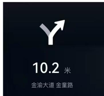
显示当前导航信息，车辆大屏导航目的地信息同步在仪表显示屏上实时显示。
