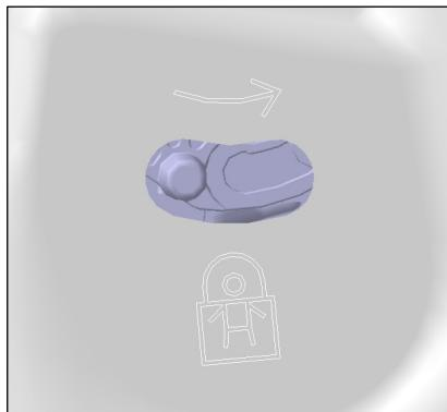
锁栓处于“闭锁”位置时，从车内不能打开该车门。打开此车门，需使用车外的车门把手。
