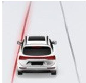
LAS 仅开启预警时,车辆发生严重偏离车道线时,仪表显示屏上的一侧车道线显示红色。
