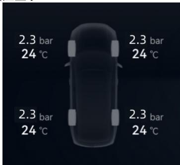
轮胎的压力和温度可以通过胎压传感器检测后，在仪表显示屏上实时显示。
