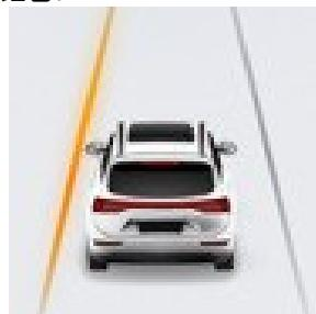
LAS 仅开启预警+纠偏时,车辆发生严重偏离车道线时,系统提供辅助转向控制并阻止车辆偏离,仪表显示屏上的一侧车道线显示红色后变为黄色。
