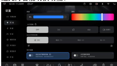
**远近光灯智能切换功能开启：**在大灯控制中将灯光切换到自动，系统会结合当前行车环境状况，在近光灯与远光灯之间自动切换。
