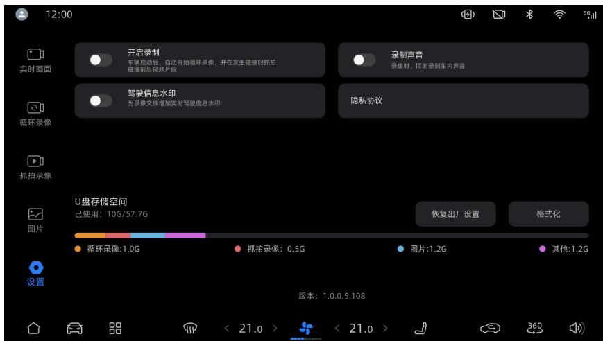
中控屏可对行车记录仪的参数进行设置。在行车记录仪界面，触摸左侧设置按钮，进入设置界面，可以对开启录制、录制声音、驾驶信息水印、恢复出厂设置、格式化等进行设置。
