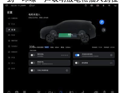
6. 通过中控屏设置>能量界面操作，插枪完成后会弹窗确认是否开启对外放电，点击开启即可开始对外放电，如非立即放电也可选择取消后在能量界面点击开始放电按钮开启对外放电。用户可在放电限值中设置放电百分比。
