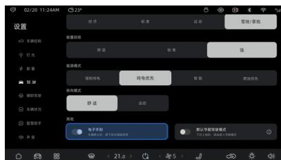
在中控大屏点击 **设置>驾驶>其他**，开启**电子手刹**，仪表驻车指示灯 **P** 点亮，即可切换到 P 挡。
