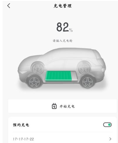
1. 停稳车辆，将车辆挡位切换至驻车 P 挡，车辆充电枪连接，车辆未执行充电；
